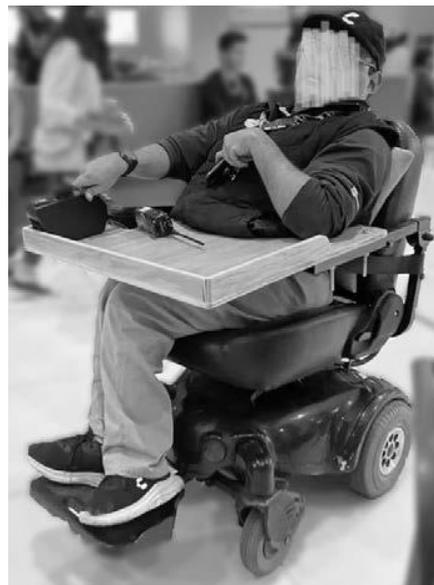
A partir de la evaluación funcional se determinó que era necesario realizar unas adecuaciones previo a realizar el prototipo en CNC. Las adecuaciones consistían en modificar la curvatura, eliminar el borde anterior y modificar la forma y dimensiones de los bordes laterales.
