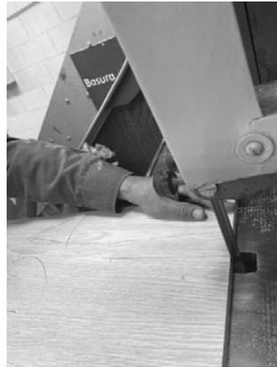
Después se lijo y se le hicieron los barrenos que necesitaba para fijarla a la silla de ruedas.
