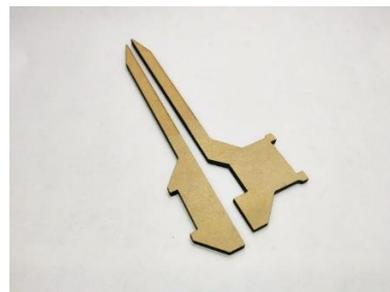
Figura 6, Piezas base para funcionamiento de antropómetro.
