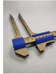
Figuras 18 y 19, Modelos prueba de piezas plásticas para antropómetro con puntas intercambiables.
