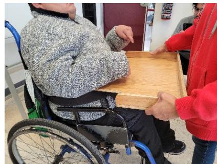
En esta alternativa el borde era alto, le estorbaba para realizar ciertos movimientos, además de que, al ser únicamente dos soportes tubulares que se anclaban al apoyo para brazos, lo hacía estructuralmente inestable, sin la rigidez y soporte necesarios.
