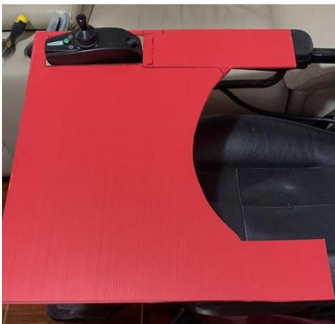
Una vez colocada la superficie en la silla de ruedas, se hizo un rápido estudio con el usuario y se observó que uno de los soportes que iban hacia los reposabrazos no era necesario, por lo que se eliminó y se corrigió un poco la curvatura para hacer el primer modelo funcional en triplay.
